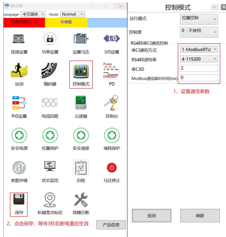
图 3-1 上位机设置 Modbus-RTU 通信参数
